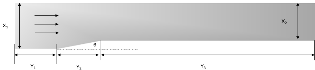
Рис.4. Геометрия расчетной области (плоский канал с клином)
