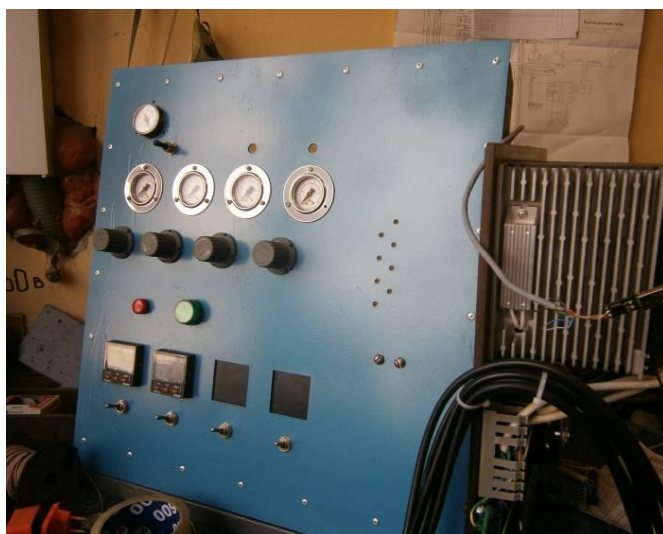
Рис. 3.19. Размещение в пульте управления установки послойного моделирования пневматических компонентов (слева) и электрических компонентов (справа)
