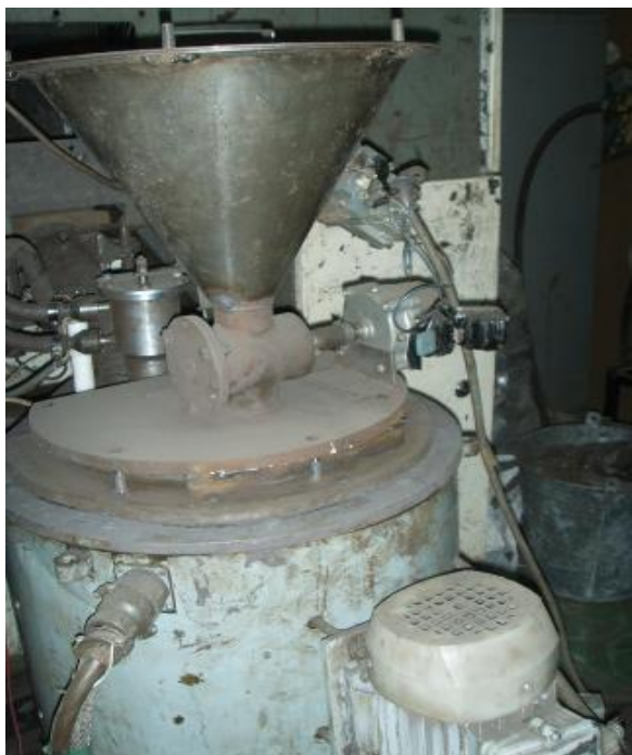
Рис. 3.2. Бак установки ФКЛ-100 с установленным на него вибродозатором для замеса шликера
