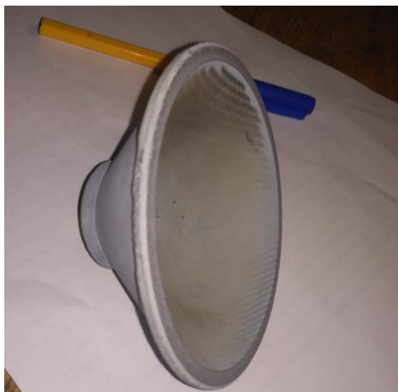
Рис. 4.11. Коническая камера после 8 часов эксплуатации в составе лабораторной модели
