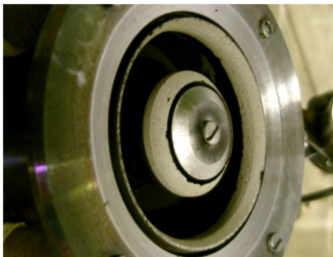
Рис. 4.4. Фото модели модели СПД после длительных испытаний[123]
