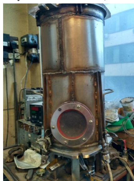
Рис. 3.4. Стенд для вакуумирования экспериментальных шликеров
