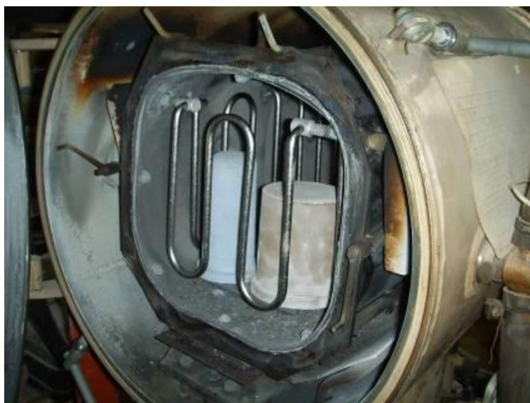
Рис. 3.13. Вакуумная печь СНВЭ-1.3.1/16-3 (с открытой дверцей), применяемая для РСНК
