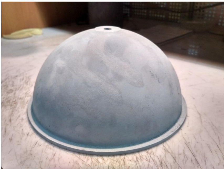
Рис. 4.16. Сферическая камеры ВЧ ИД-16 из керамики системы Al_2O_3 - Si_3N_4
