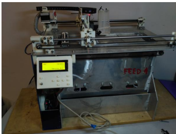
Рис. 3.20. Внешний вид установки трехмерного моделирования методом впрыска связующего
