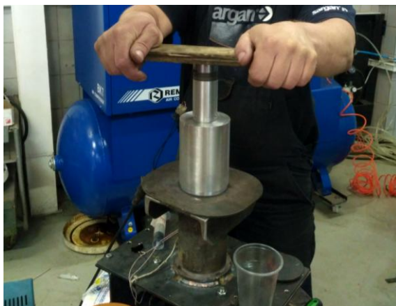
Рис. 3-44. Эксперимент по обработке УЗ уплотнения порошка
