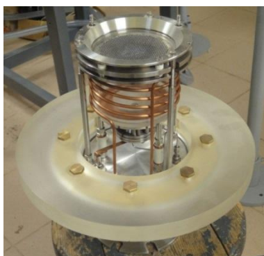
Рис. 4.8. Фото ВЧИД-10: а) без кожуха; б) с защитным кожухом
