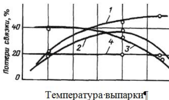
Рис. 3.26. Влияние состава минеральных порошков-адсорбентов, применяемых для засыпки и температуры выпарки, на процесс удаления связки. Цитируется по [106]
