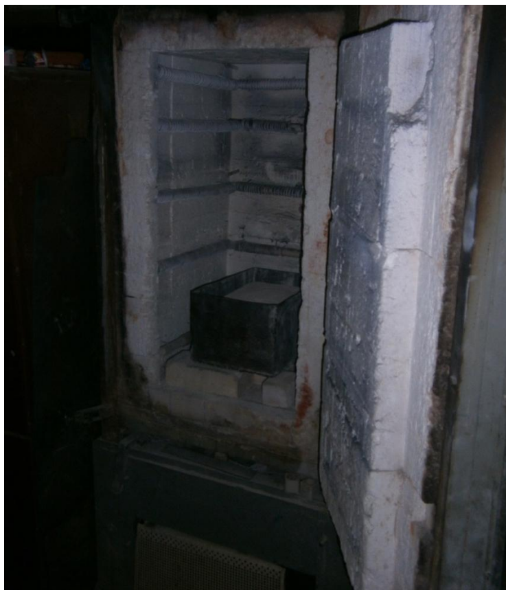
Рис. 3.32. Камерная лабораторная электропечь СНОЛ 240/11 с коробкой внутри
