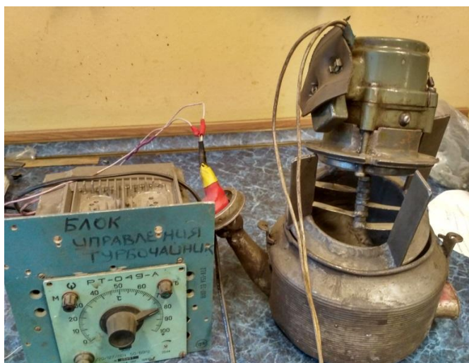
Рис. 3.3. Устройства для ручного замешивания малых количеств экспериментальных шликеров
