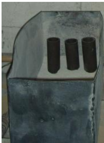
Рис. 3.29. Изделия, полученные ГЛК и трехмерным моделированием в коробке с порошковым-адсорбентом, порошок-адсорбент еще не полностью засыпан
