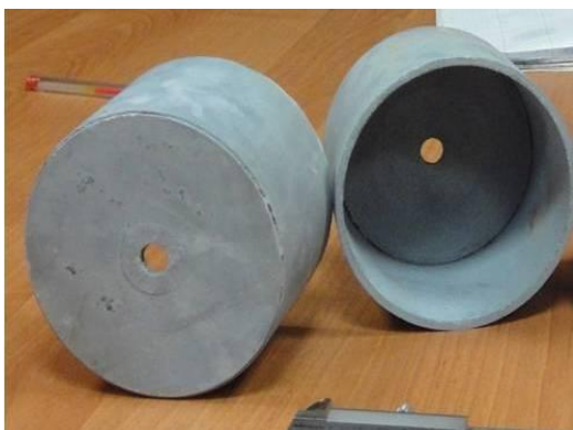
Рис. 4.7. Исследуемые РК: а) нитрид кремния и композит Al_2O_3 - Si_3N_4 ; б) корунд ВК-100-2
