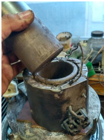
Рис. 3-5. Обогреваемый инжектор для отливки испытательных образцов из малых количеств экспериментальных шликеров
