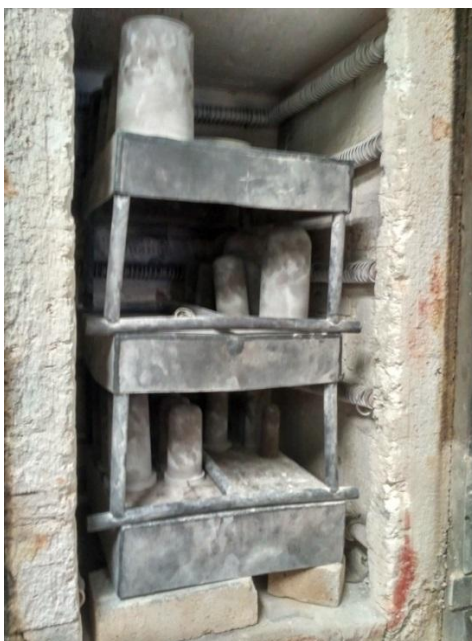
Рис. 3.6. Унифицированные приспособления для выжига связки из заготовок и прокалки засыпки-адсорбента в печи СНОЛ 240/11
