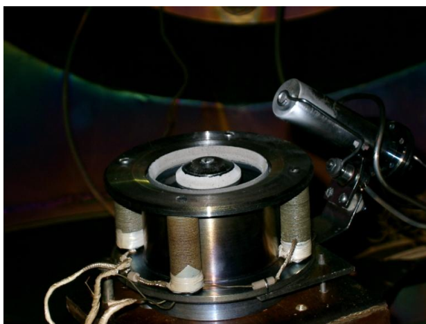
Рис. 4.2. Фото и конструктивная схема модели СПД [123]
