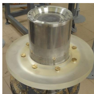
Рис. 4.8. Фото ВЧИД-10: а) без кожуха; б) с защитным кожухом
