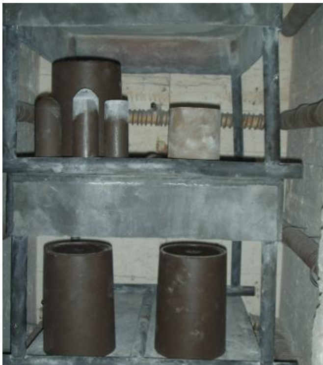
Рис. 3.12. Заготовки, полученные методом ГЛК, в прокалочной печи типа СНОЛ 240/11
