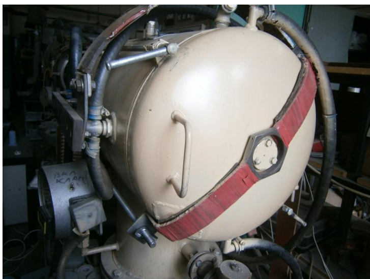
Рис. 3.8. Внешний хомут для стягивания крышек печи СНВЭ-1.3.1/16-3
