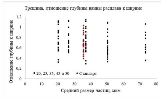
Рисунок 10 – Отношения глубины ванны расплава к ее ширине при появлении трещины
