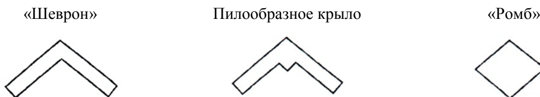
Рис. 20 – Формы крыла в плане с параллельными кромками [11]
