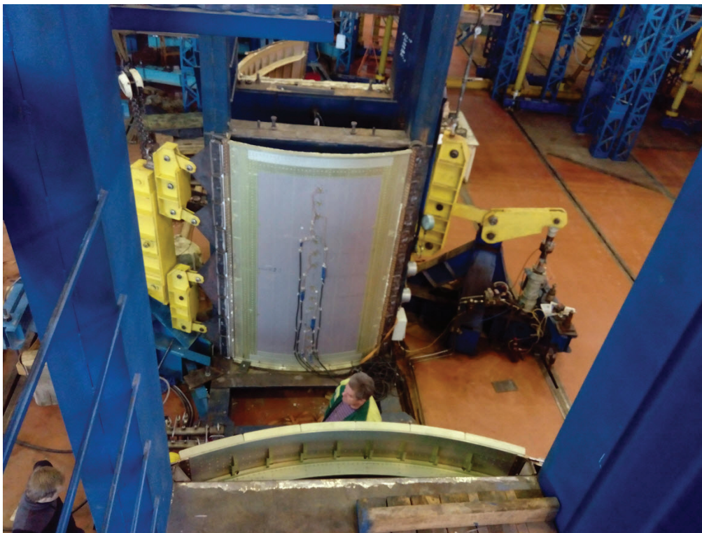
Рис. 2. Вид поверхности панели фюзеляжа в процессе подготовки к испытаниям
