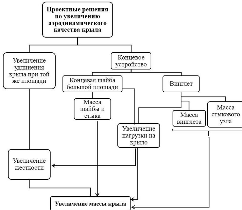
Рисунок 1 – Причинно-следственная связь, ведущая к росту массы крыла в итоге разных проектных решений по улучшению его аэродинамического качества
