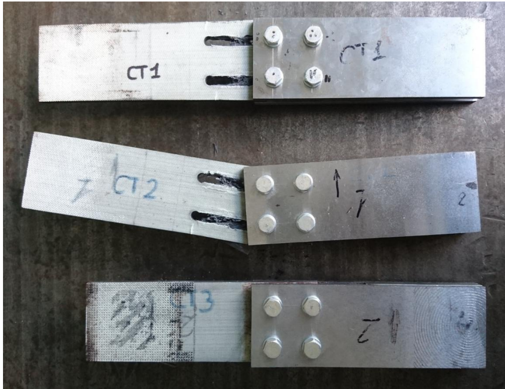
Рисунок 4.14- Образцы после испытаний при статическом растяжении
