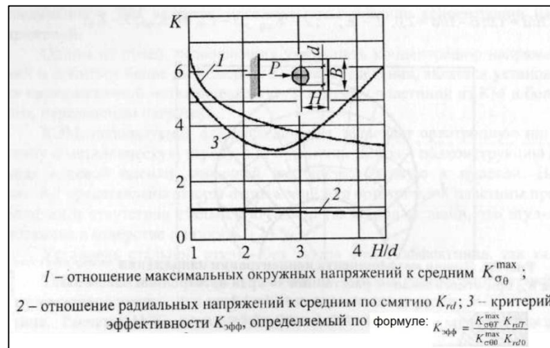
Рисунок 4.4 – Зависимость коэффициентов концентрации напряжений от относительного расстояния H/d до края ортотропной пластины при относительной ширине пластины d/B=0,3
