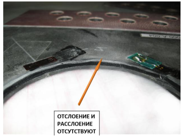
Б) Образец с упрочненным наноклеевой композицией отверстием
