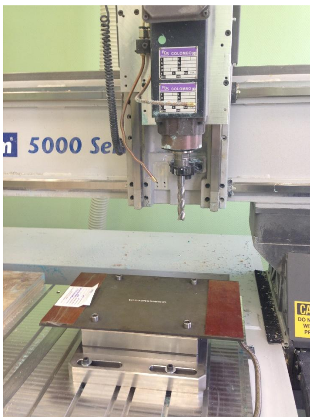
Рисунок 3.4 – Углепластиковая пластина, установленная на специализированном комплексе оборудования для измерения усилий резания при фрезеровании на обрабатывающих центрах с ЧПУ
