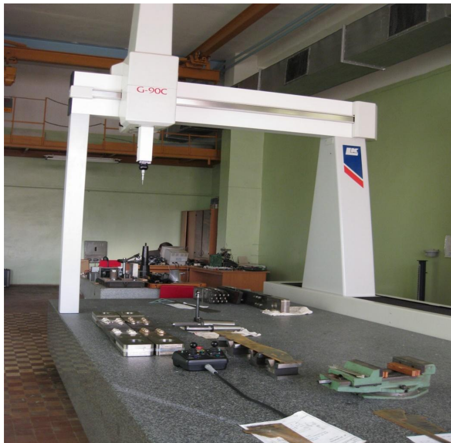
Рисунок 1.9 – Используемая для проведения измерений координатная контрольная машина LKG-90C
