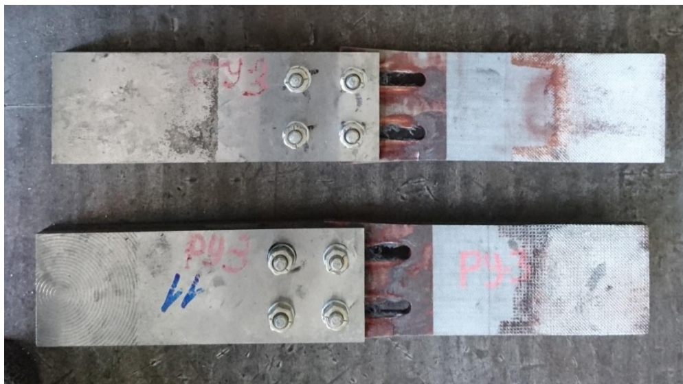
Рисунок 4.16.- Образцы STU3 и PU3 после испытаний на ресурс с последующим статическим растяжением
