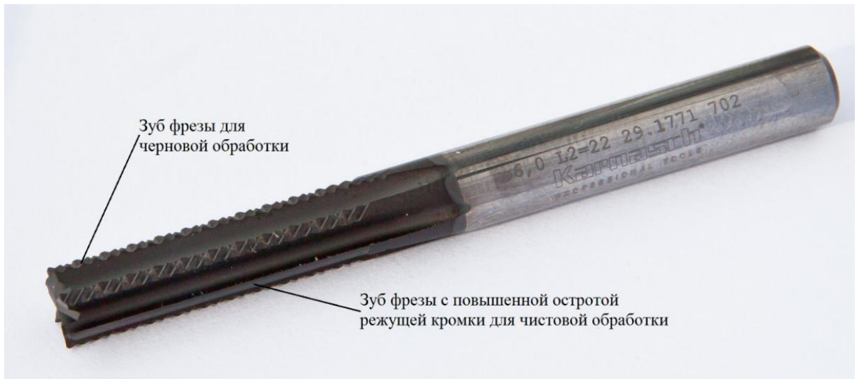
Рисунок 3.9 – Инструмент ф. Karnasch, включающий зубцы для черновой и чистовой обработки
