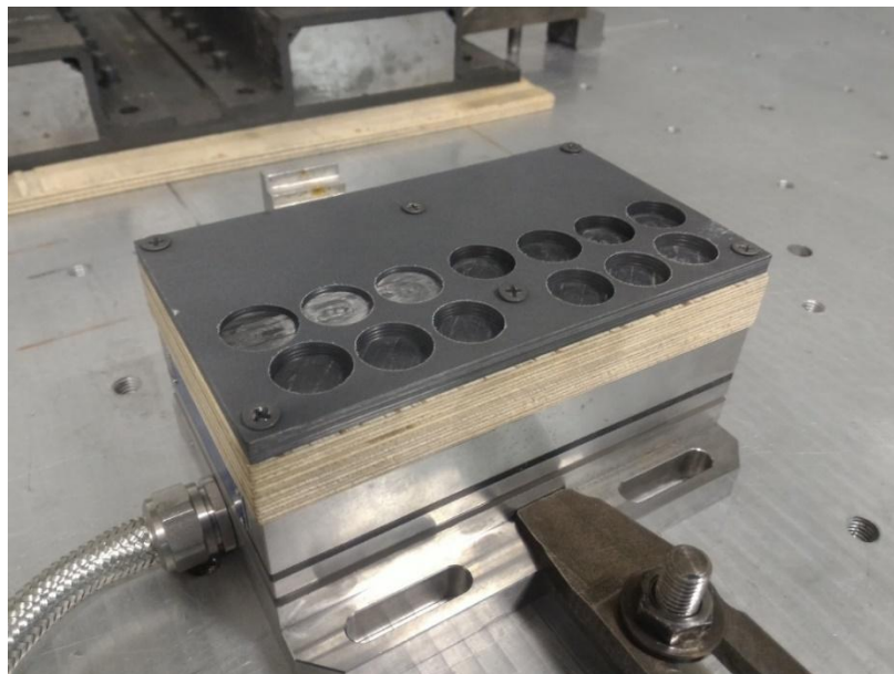
Рисунок 3.13 – Кварцевый многокомпонентный динамометр тип 9257BA с опытным образцом
