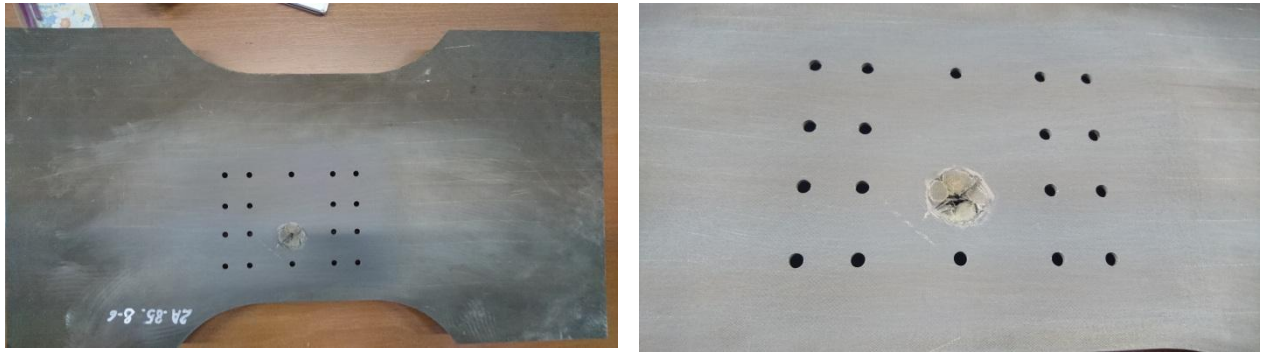
Рисунок 4.51 – Зачищенная поверхность ремонтируемой панели, вид снаружи
