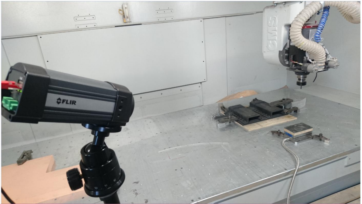
Рисунок 3.17 – Тепловизор установленный в рабочей зоне станка с ЧПУ
