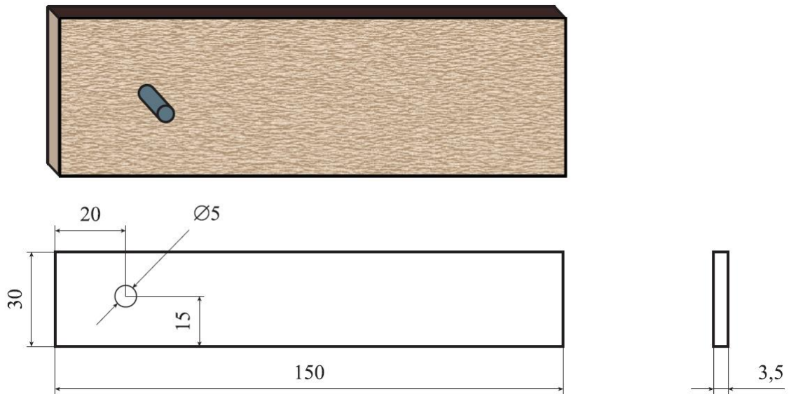
Рисунок 2.16 Схематичное изображение образца из углепластика со штифтом
