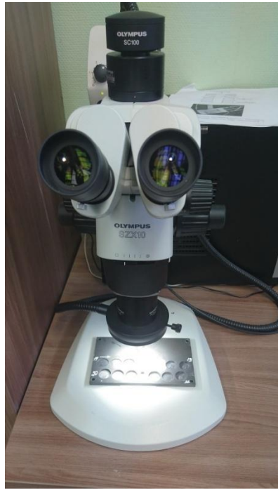
Рисунок 3.21 – Оптический микроскоп Olimpus SZX10 с установленным образцом для микроскопии
