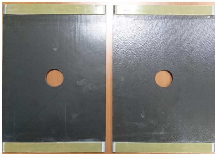
Рисунок 4.39 – Образцы с механически удаленной поврежденной зоной
