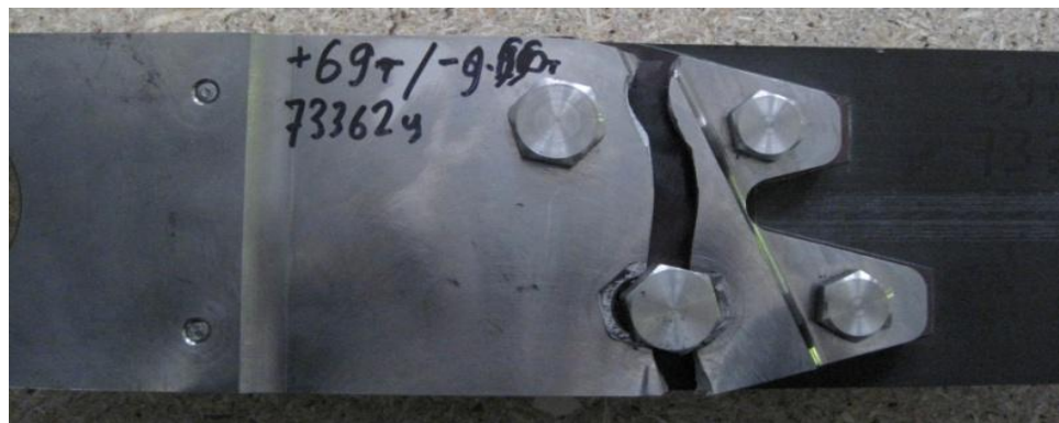
а) разрушение захвата в зоне передних болтов \text{Ø}16 мм.
