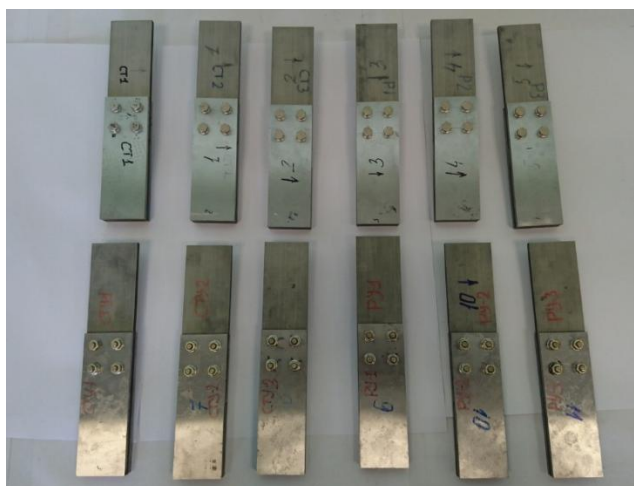
Рисунок 4.13 – Общий вид подготовленных для проведения прочностных испытаний 12 образцов металло-композитных соединений (верхний ряд образцы в исходном состоянии, нижний ряд образцы упрочненные НКК)
