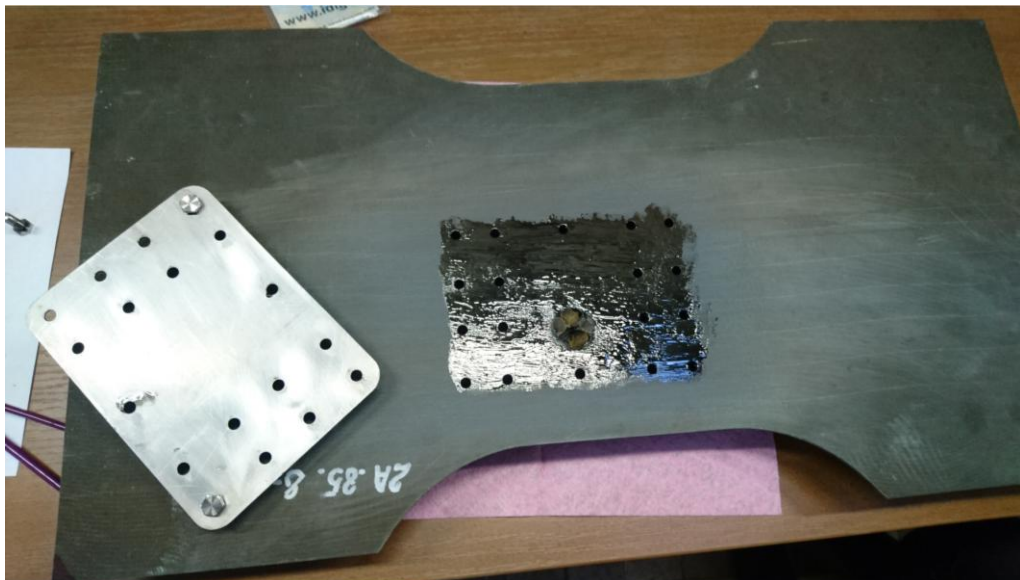
Рисунок 4.53 – Нанесение наномодифицированной клеевой композиции на все контактные поверхности
