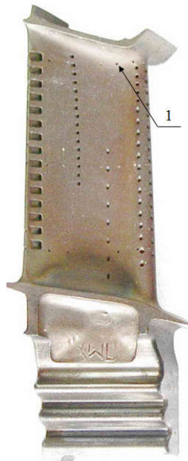
Рис. 3.6 Дополнительное охлаждение подполочного сечения, 1 – дополнительные отверстия [57]
