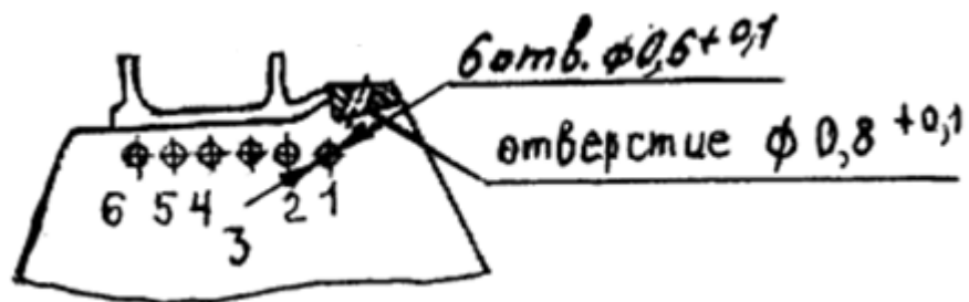
Рис. 3.7 Пример охлаждения бандажной полки, в полочном сечении на корыте лопатки [48]
