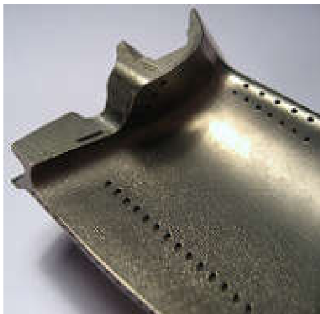
Рис. 3.9 Различные способы конвективного охлаждения контактных граней бандажных полок лопаток ТВД
