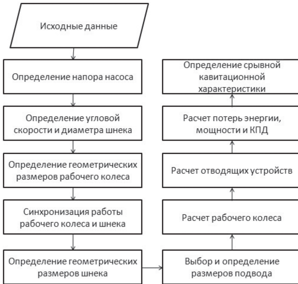
Рис. 4. Блок-схема математической модели расчетного режима
