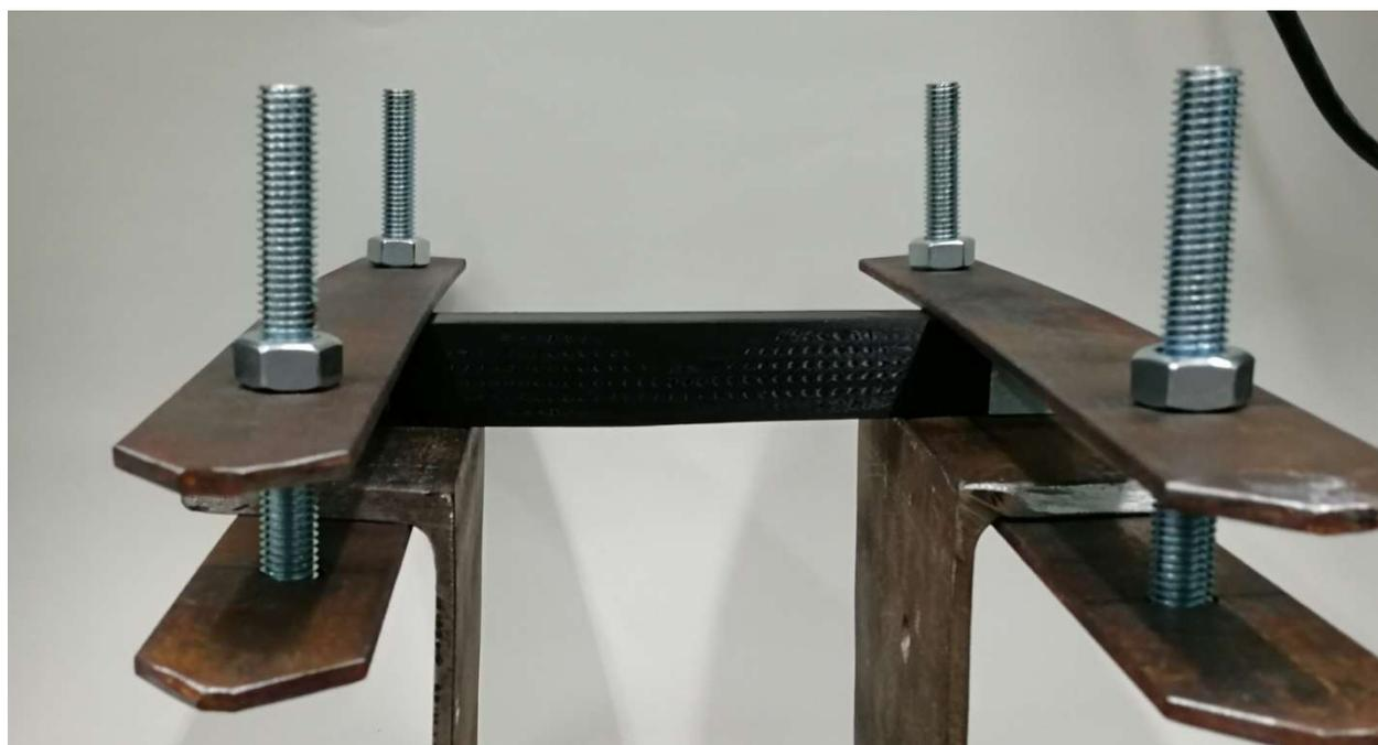
Рисунок.3.15 – Испытуемый образец
