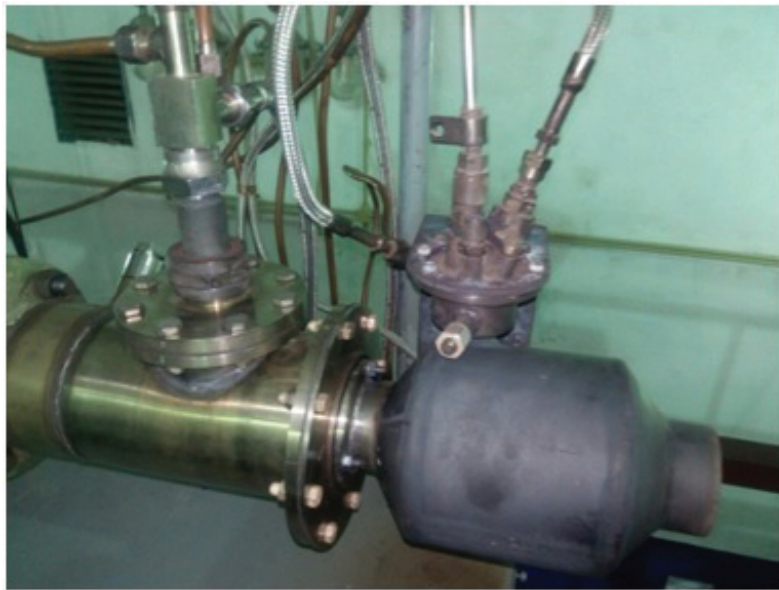
Рис. 3. Размещение горелки в имитаторе жаровой трубы
