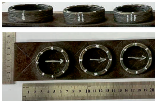
Рис. 3. Калибровочные кольцевые образцы
