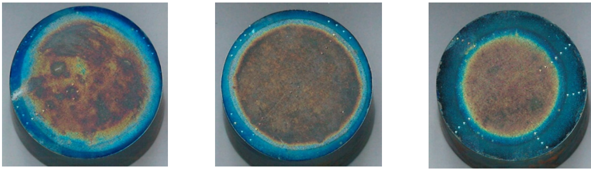
а б в Рисунок 3.18 – Поверхность образцов \varnothing 40 мм после закалки с выдержкой при нагреве 7 (а), 10 (б) и 14 (в) секунд
