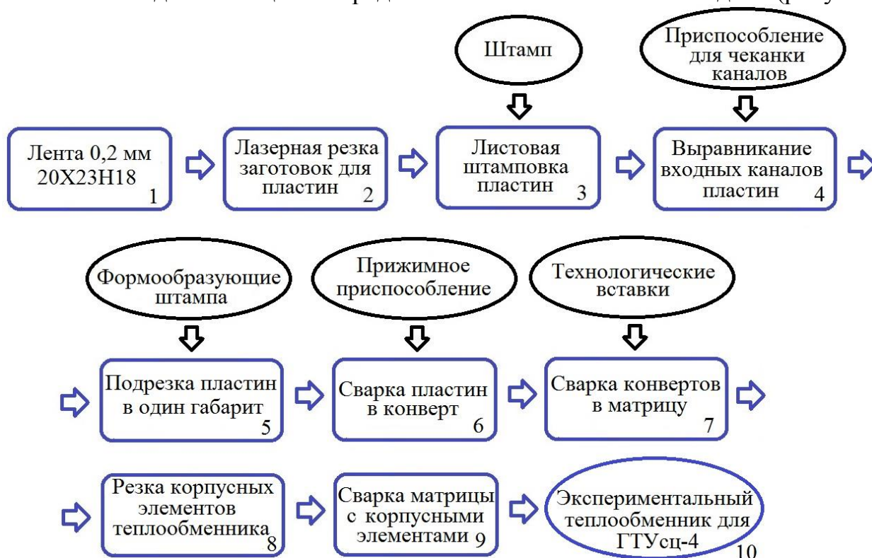
Рисунок 9 – Последовательность создания экспериментального теплообменника для ГТУсц-4
