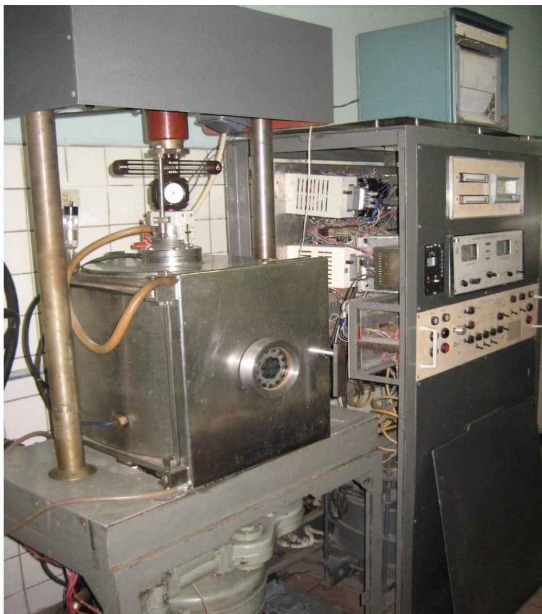
Рисунок 2.5 – Универсальная сварочная диффузионная вакуумная установка СДВУ-50
