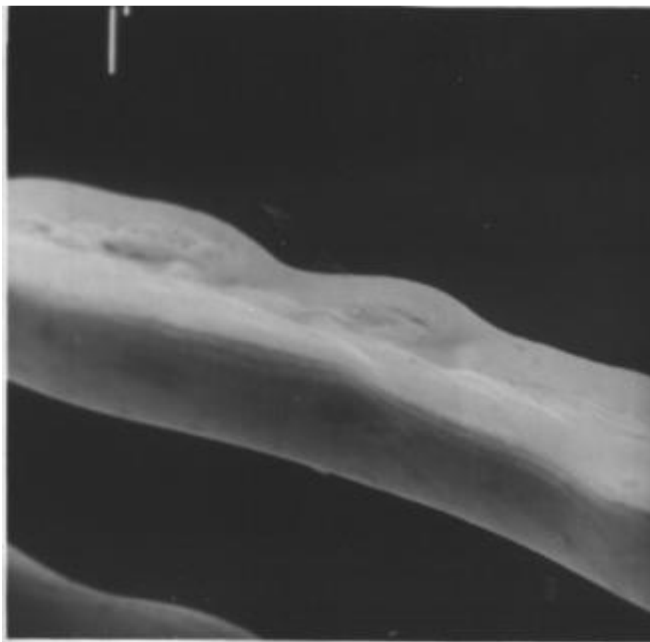
Рисунок 2.7 – Поверхность волокна из титана марки ВТ 1-0
