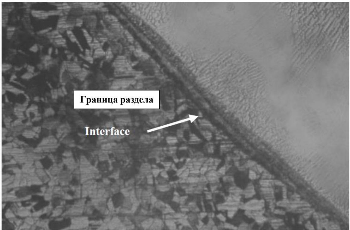
Рисунок 1.12 – Микроструктура покрытия, полученного холодной сваркой [75]
