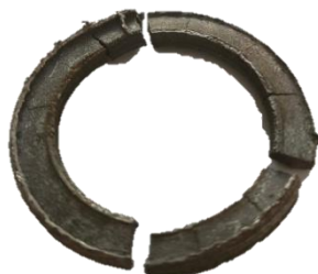
Рисунок 4.4 – Образец после горячего прессования при 1000 °С
