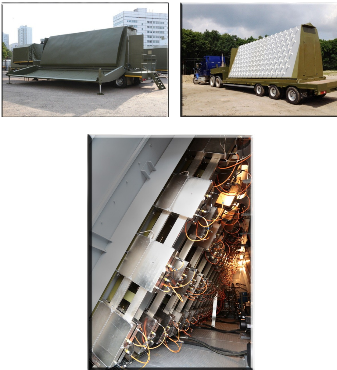
Рис. А1. Мобильная РЛС «Демонстратор» (вверху). Установка передатчиков на трубах охлаждения (внизу).
