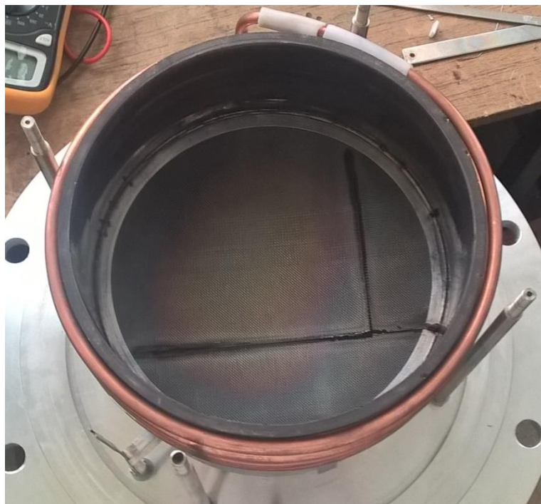
Рисунок 3.28 – Разрушение разделительной сетки в ВЧИД-15-2.
