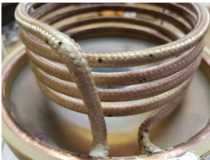
Рисунок 3.30 – Внутренний цилиндрический индуктор ВЧИД-15-3. «Привязки» от разряда присутствуют на всех частях индуктора.
