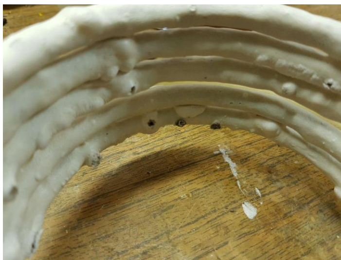
Рисунок 3.32 – Внутренний цилиндрический индуктор ВЧИД-15-3. Отчетливо видны «черные области» повреждения алюмооксида.
