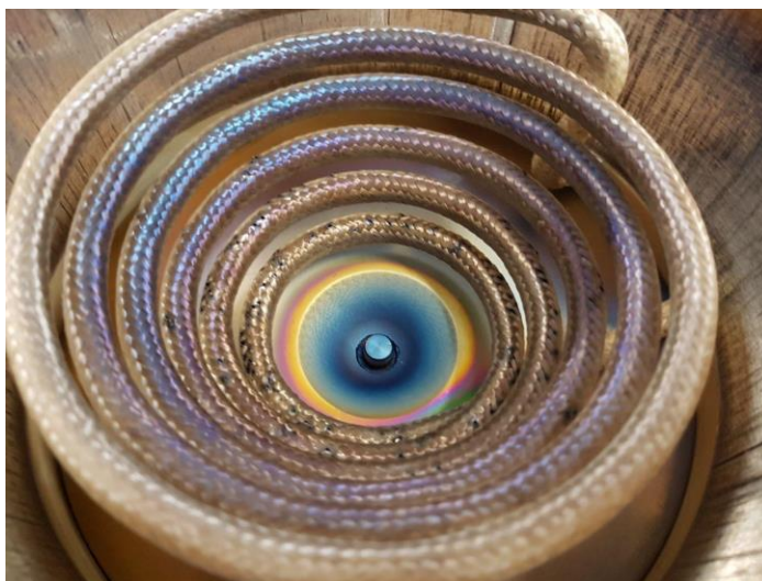
Рисунок 3.29 – Внутренний конический индуктор ВЧИД-15-3. На нижних витках видны характерные «привязки» (обгоревшие области кварцевого шнура) от разряда.
