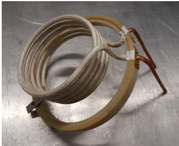
Рисунок 2.27 – Индуктор с посадочным кольцом. ВЧИД-15-3.
