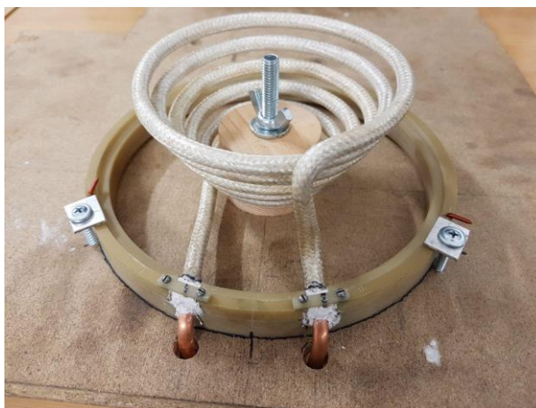
Рисунок 2.29 – Фото сборки индуктора конической формы на монтажной плите.
