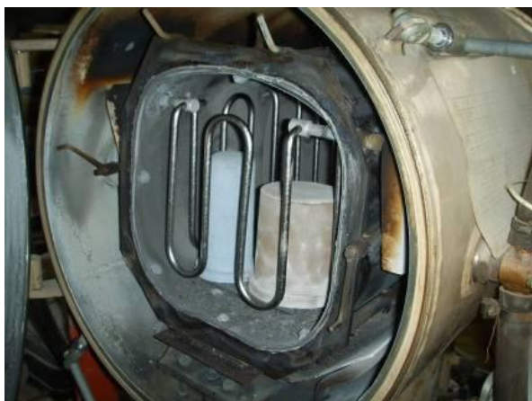
Рисунок 11 – Вакуумная печь СНВЭ-1.3.1/16-3 (слева), и установленный оптимальный температурный режим реакционного спекания (справа)
