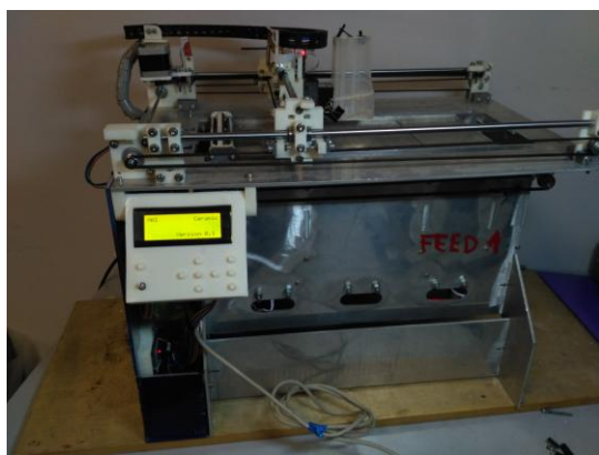
Рисунок 10 – Внешний вид установки для трехмерного моделирования методом впрыска связующего (слева) и принцип работы установки (справа)
