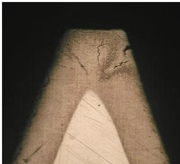
Рисунок 1.8 – Дефект азотирования на детали «Винт» из стали 05X12H2K3M2AФ (x100) [68].
