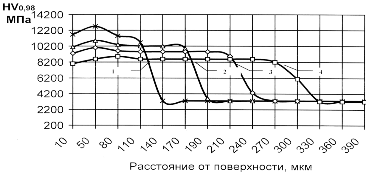
Рисунок 1.4 – Кинетика роста азотированного слоя при азотировании в многокомпонентных атмосферах: Сталь 05X12H2K3M2AФ, режимы азотирования по схемам 1-3: 1 – азотирование по схеме 1, время азотирования 9ч, 2 – азотирование по схеме 1 – 9ч, затем по схеме 2 – 9ч, общее время азотирования 18ч, 3 – азотирование по схеме 1 – 9ч, по схеме 2 – 18ч, общее время азотирования 27ч, 4 – азотирование по схеме 1 – 9ч, по схеме 2 – 18ч, по схеме 3 – 9ч, общее время азотирования 36ч [68].
