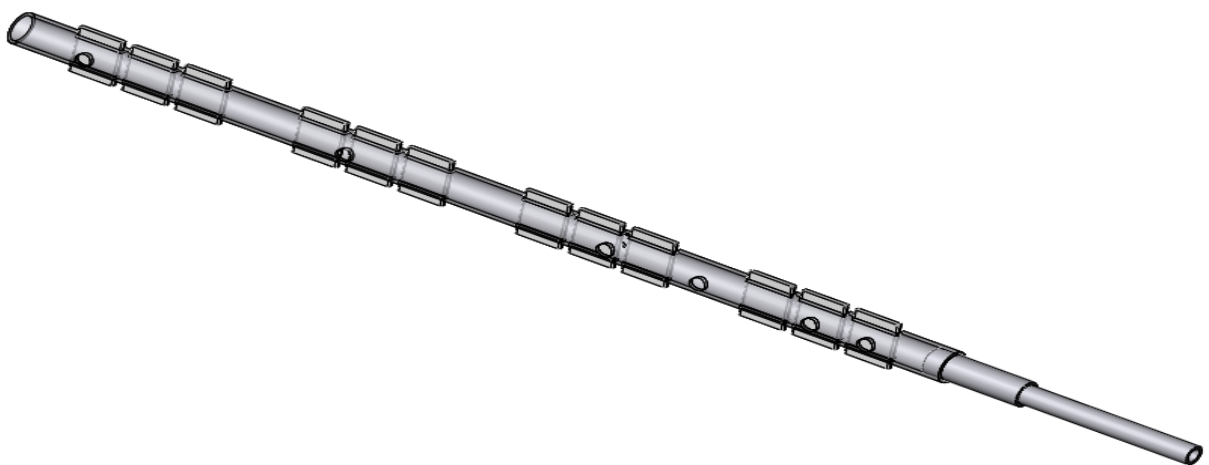
Рисунок 3.4 – Круглая труба с интенсификацией теплообмена с помощью специальных профилей
