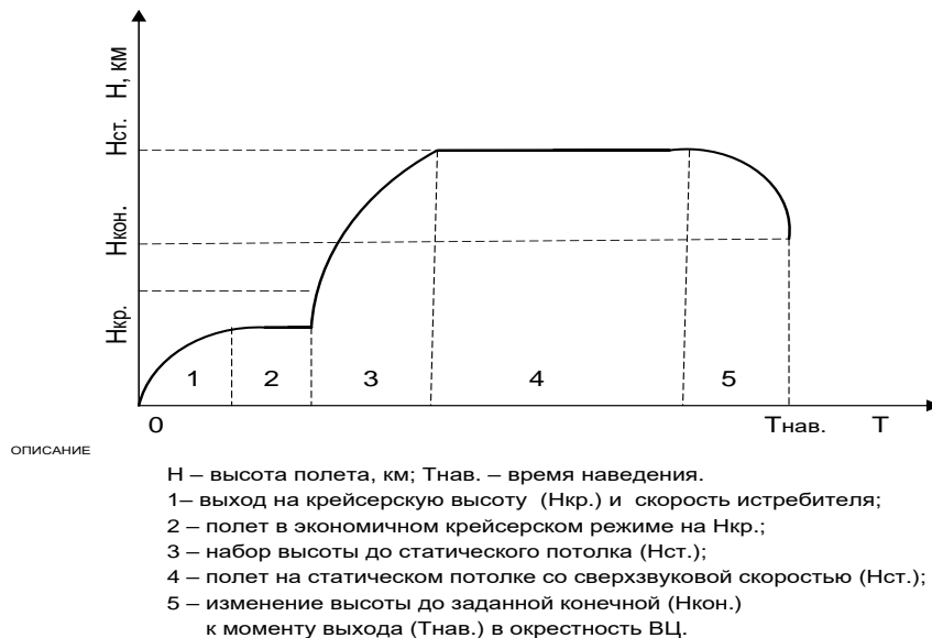
Рисунок 3.2.2.8 – Обобщенный программный закон изменения высоты при наведении МФИ на ВЦ
