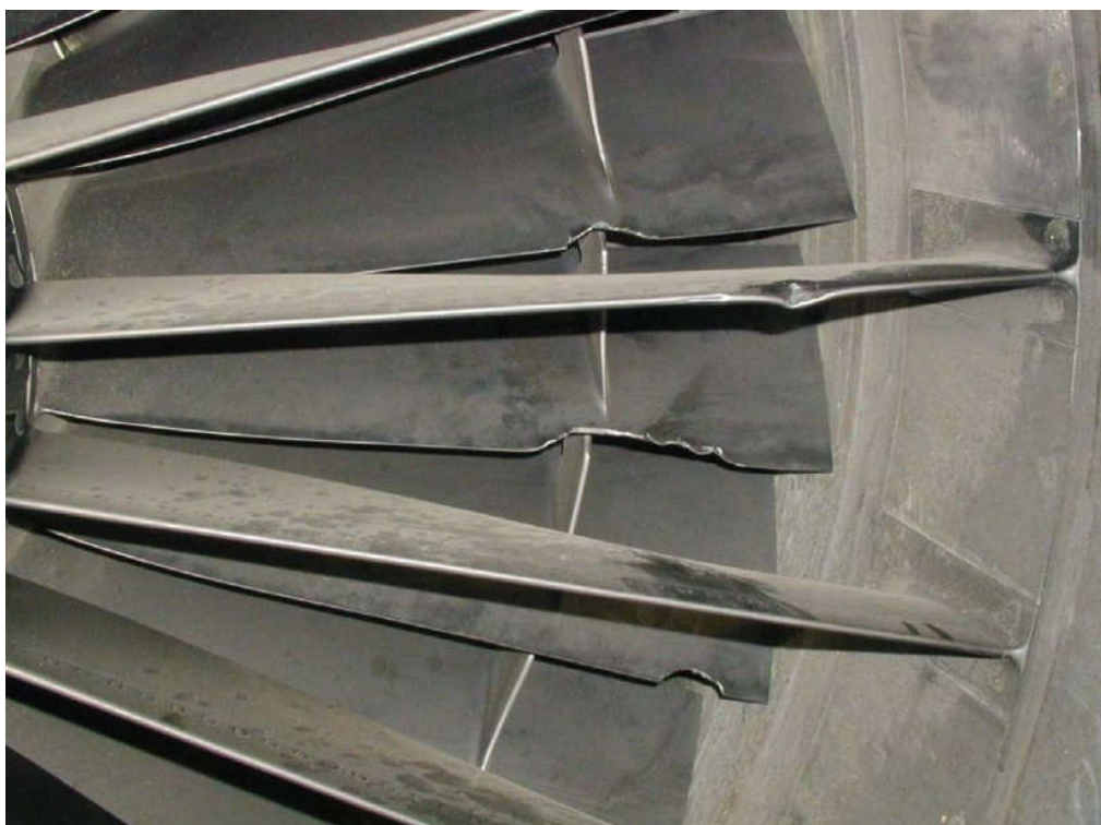
Рис. 4.20. Повреждения входных кромок лопаток первой ступени вентилятора в виде окружной забоины
