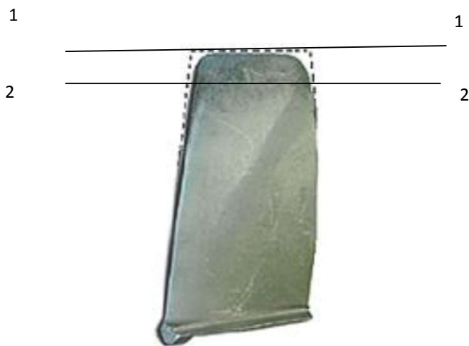
Рис. 1.2. Вид эрозионного повреждения поверхностей пера, входной и выходной кромок рабочей лопатки компрессора авиационного ТРДД
