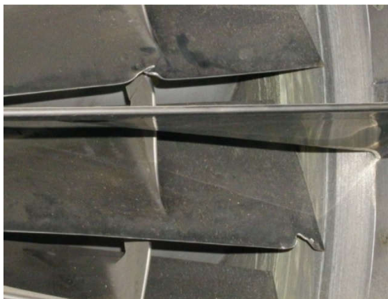
Рис. 4.19. Повреждения входных кромок лопаток первой ступени вентилятора в виде треугольной забоины
