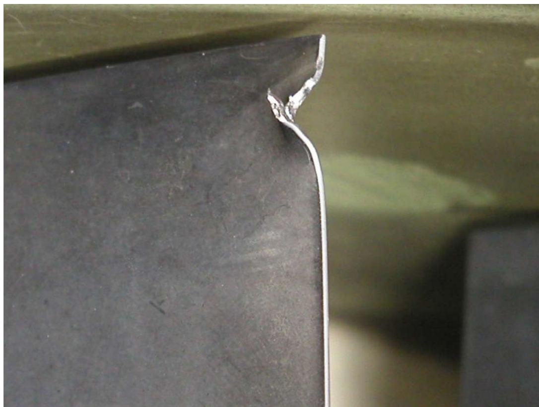
Рис. 1.4. Забоина на входной кромке лопатки первой ступени вентилятора двигателя Д-30КУ-154
