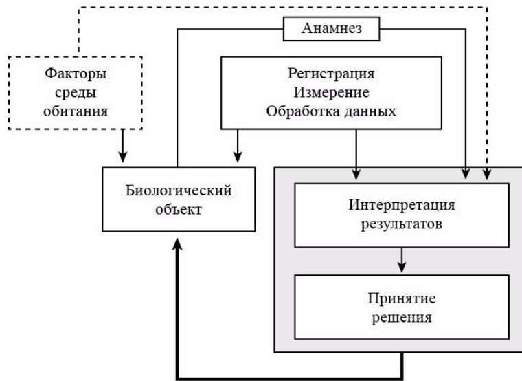
Рис. 2.1. Схема диагностической БТС
