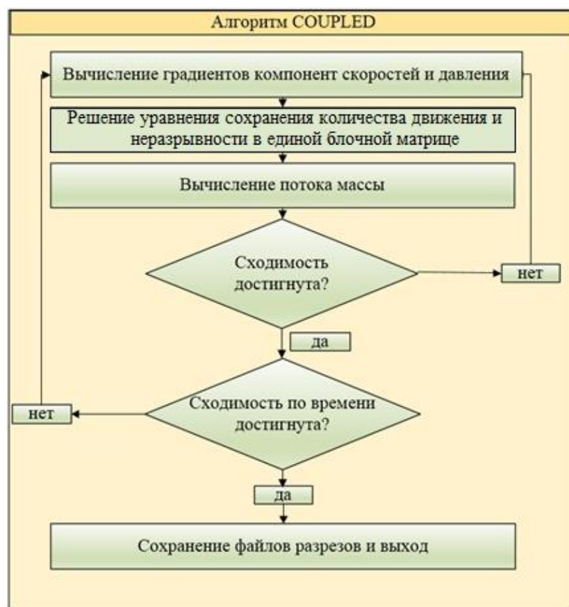
Рис. 28 – Блок-схема работы совмещенного алгоритма
