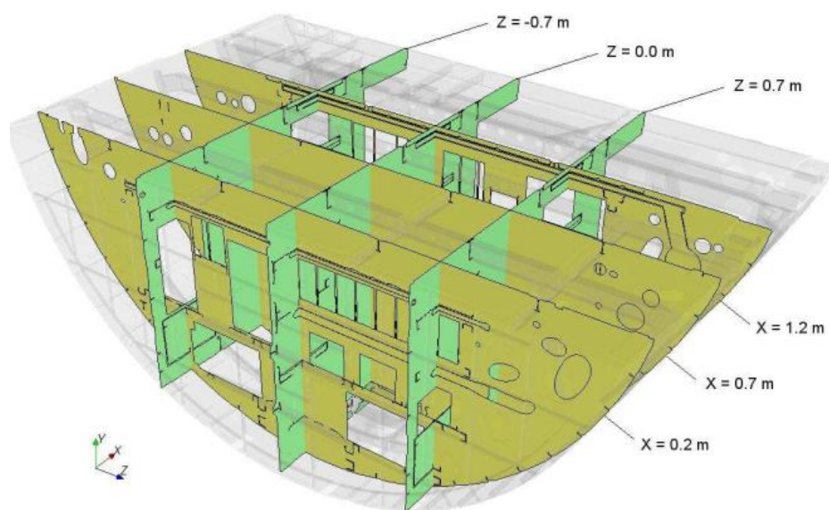
Рис. 68 – Положение контрольных сечений модели плоскостями
