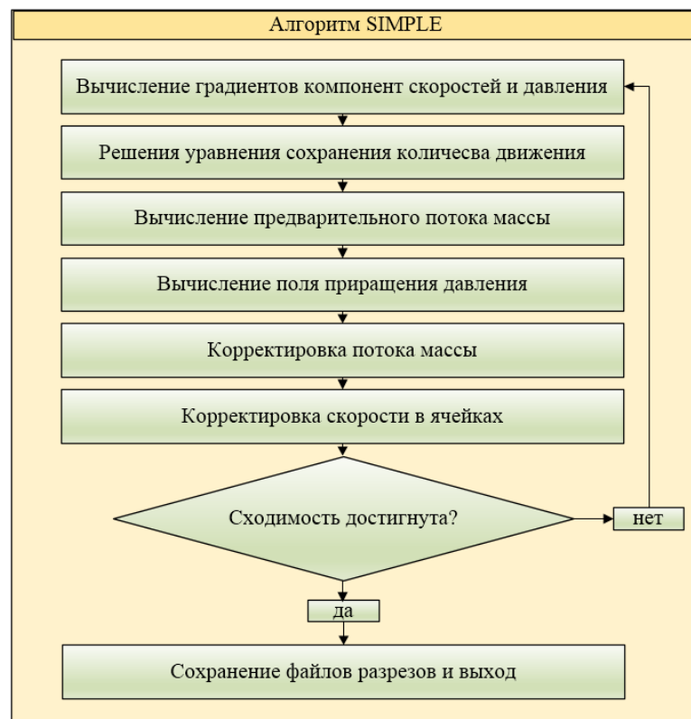
Рис. 3 - Блок-схема работы алгоритма SIMPLE
