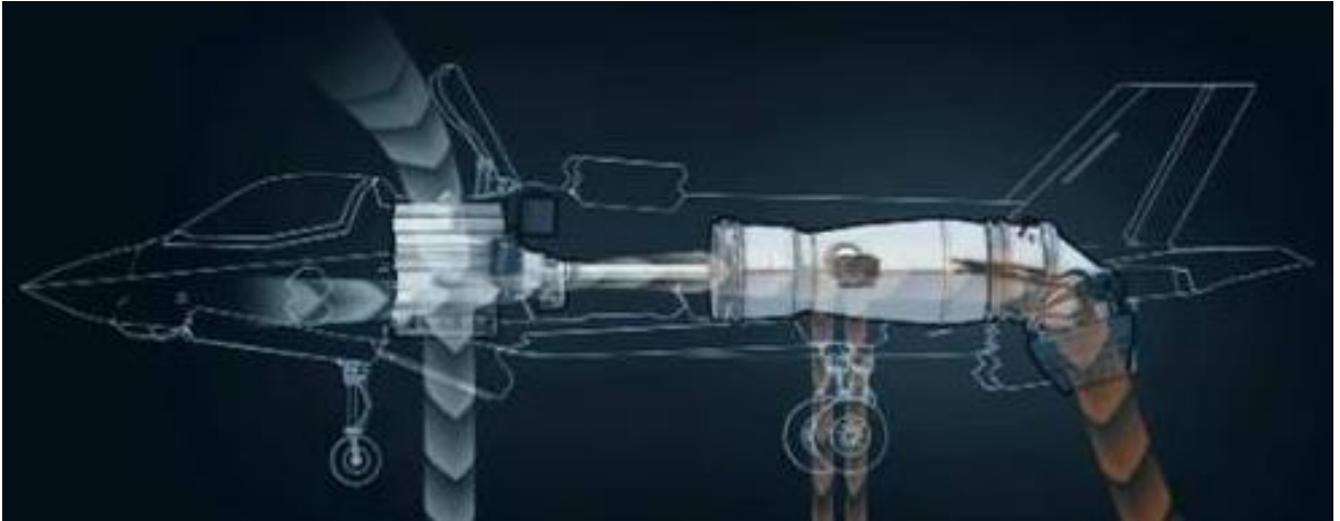
Рис 1.1. Схема поворотного двигателя в режиме вертикального взлета и посадки
