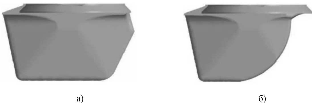
Рис. 1.7. Профиль пера газового руля в начале (а) и в конце (б) работы твердотопливного двигателя. Источник: [27].
