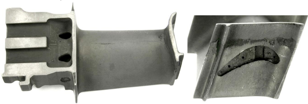
Рисунок 5.3 Внешний вид лопатки турбины с наплавкой X20H80-Н+CM64
