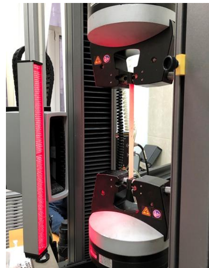
Рисунок 1. Образец перед испытанием на растяжение
