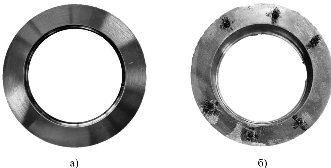
Рисунок 13 – Внешний вид пары трения для установки на базе высокоскоростной машины трения ИМ-58 (а – имитатор ротора, б – имитатор ЩУ)
