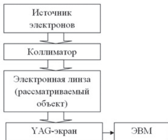
Рис. 1. Структурная схема измерения ошибки контура на специализированном оборудовании
