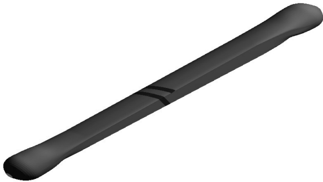
Рис. 2. Лонжерон стабилизатора вертолета и два витка ленты
