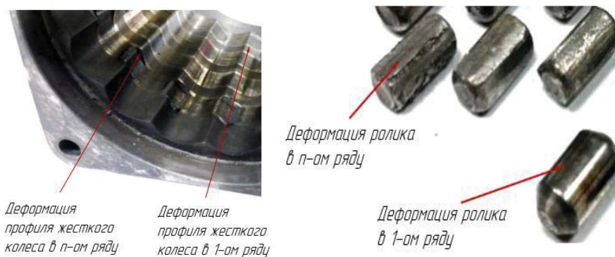
Рисунок 9 – Жесткое колесо ВПТК после ресурсных испытаний
