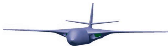
Рис. 1. Магистральный самолет с силовой установкой, размещенной в корневой части крыла (с ТРДД классической схемы)
