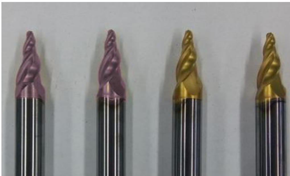
Рисунок 5.3. Твердосплавные концевые фрезы для обработки лопатки после нанесения композиционного покрытия
