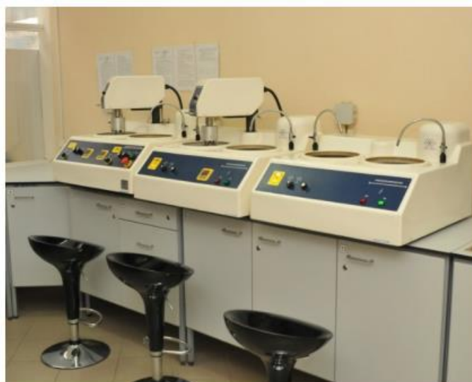
Рисунок 2.1. Двухдисковые шлифовально-полировальные станки P25FRS TopTechMachines
