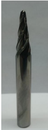
Рисунок 5.2. Твердосплавная концевая фреза для обработки лопатки до нанесения композиционного покрытия
