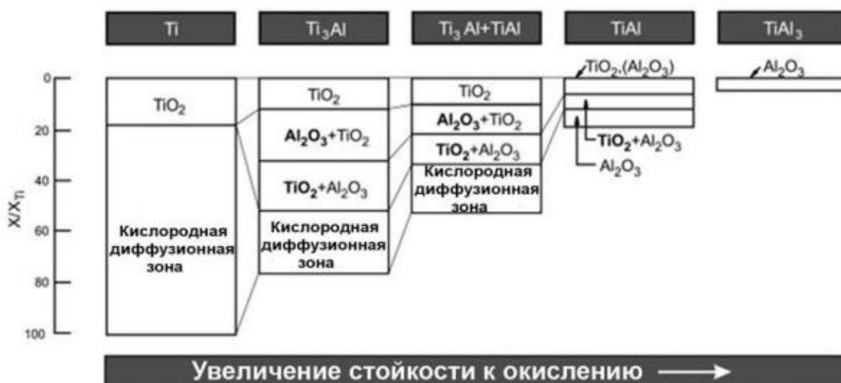
Рисунок 1.13. Схема строения оксидной пленки
