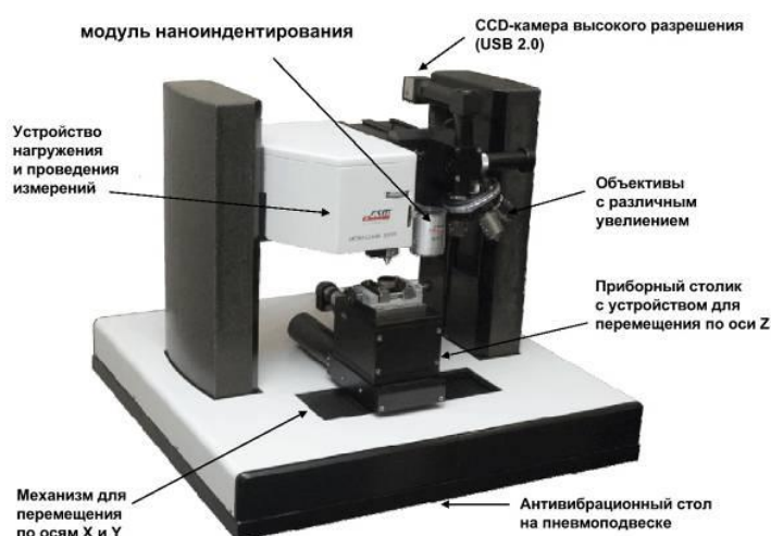
Рисунок 2.11. Внешний вид установки «CSM Scratch Test»
