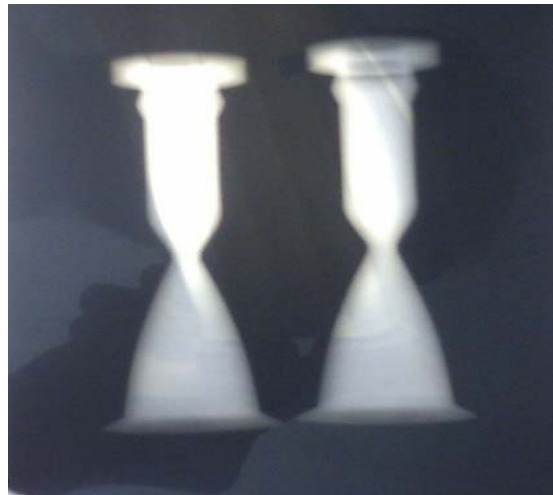
Рисунок 14. Рентгеновские снимки макетов корпусов КС.
