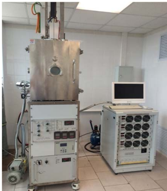
Рисунок 2. Общий вид установки магнетронного напыления МРМ-1.
