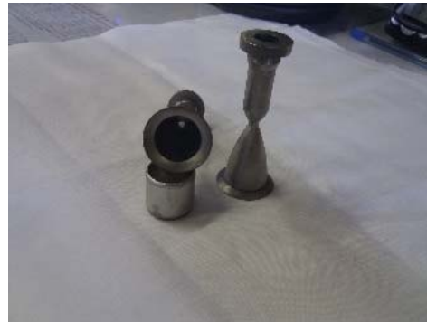
Рисунок 13. Корпуса КС после вытравливания оправки.
