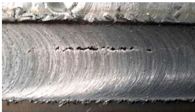
Рисунок 3.5 – Внешний вид шва ДУАКМ с содержанием частиц Al_2O_3 в пределах 4–6%, выполненного при значении V_{св}/\omega равном 0,32 мм/об
