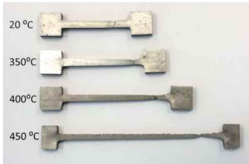
Рисунок 4.13 – Образцы из зоны перемешивания сварного соединения сплава Д16АТ, испытанные при различных температурах
