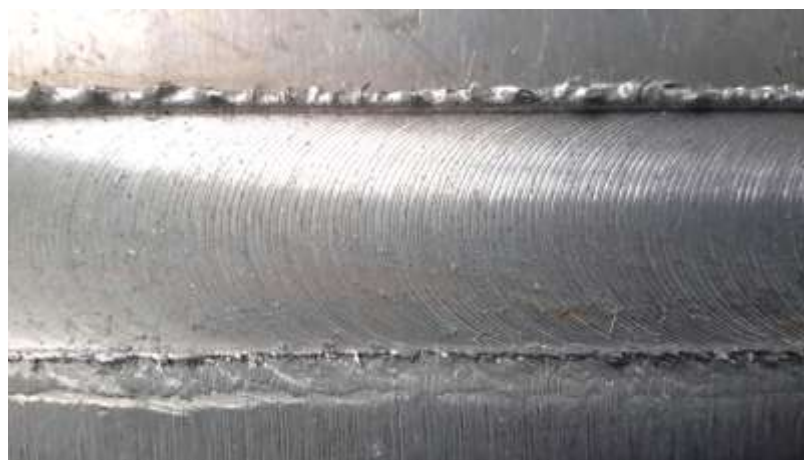
Рисунок 3.6 – Внешний вид шва ДУАКМ с содержанием частиц Al_2O_3 в пределах 13–15%, выполненного при значении V_{св}/\omega равном 0,25 мм/об
