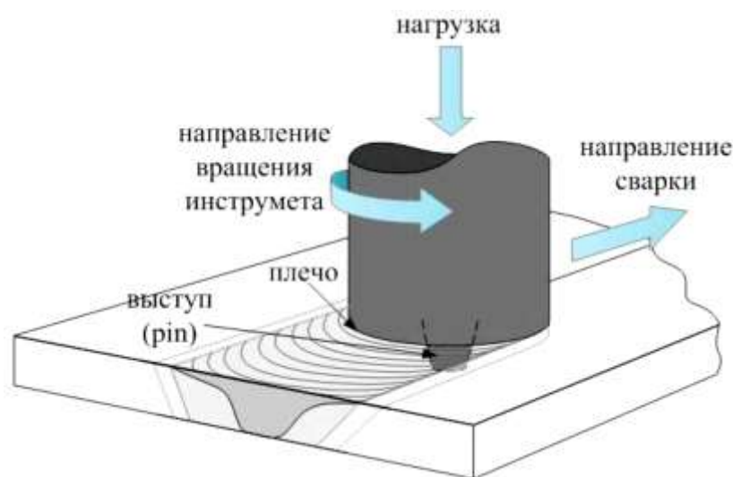
Рисунок 1.14 – Схема процесса сварки трением с перемешиванием
