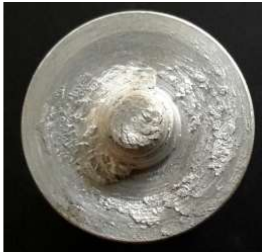
Рисунок 5.13 – Налипание материала заготовки на рабочую часть инструмента при сварке трением с перемешиванием
