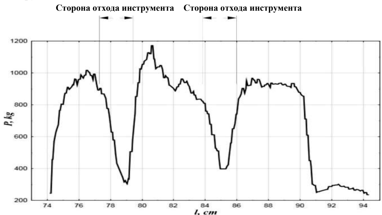
Рисунок 5.16 – Изменение сопротивления движению инструмента при СТП пластин сплава 1565чМ толщиной 8 мм
