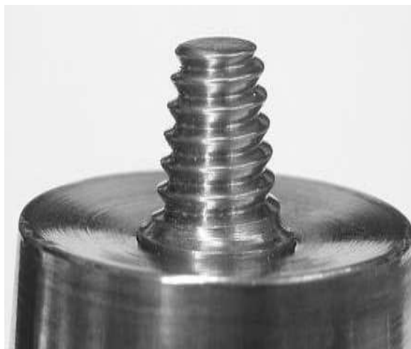
Рисунок 5.11 – Рабочий инструмент для сварки стыковых соединений сплава 1565чМ толщиной 8 мм
