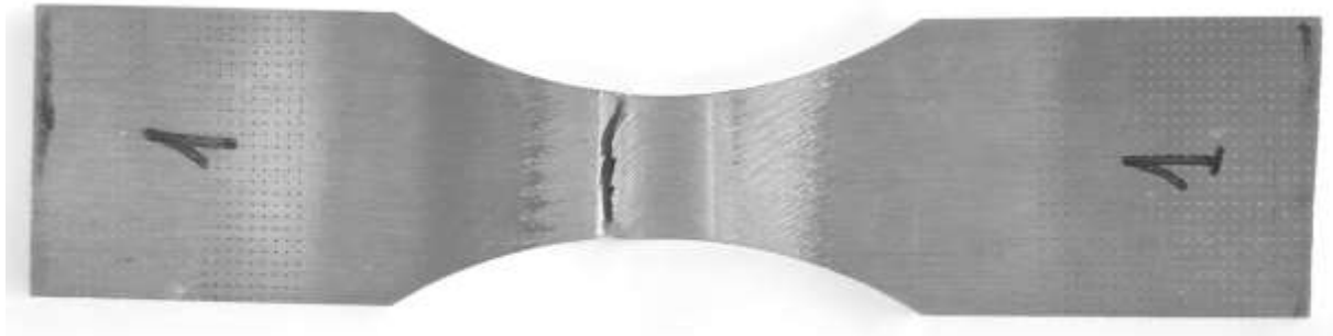
Рисунок 5.3 – Разрушение образца сварного соединения сплава системы Al–Cu–Mg, выполненного сваркой трением с перемешиванием, при растяжении
