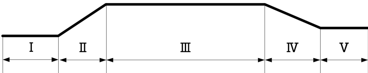
Рисунок 4.1 – Участки профиля полетного цикла
