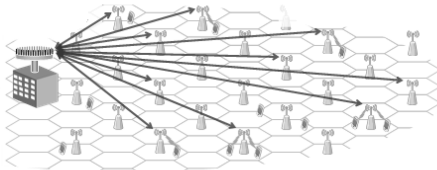
Рисунок 1.2 - Система связи «точка-многоточка»
