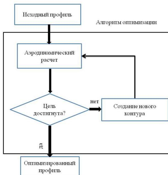
Рис. 1 Блок-схема прямого метода численной оптимизации
