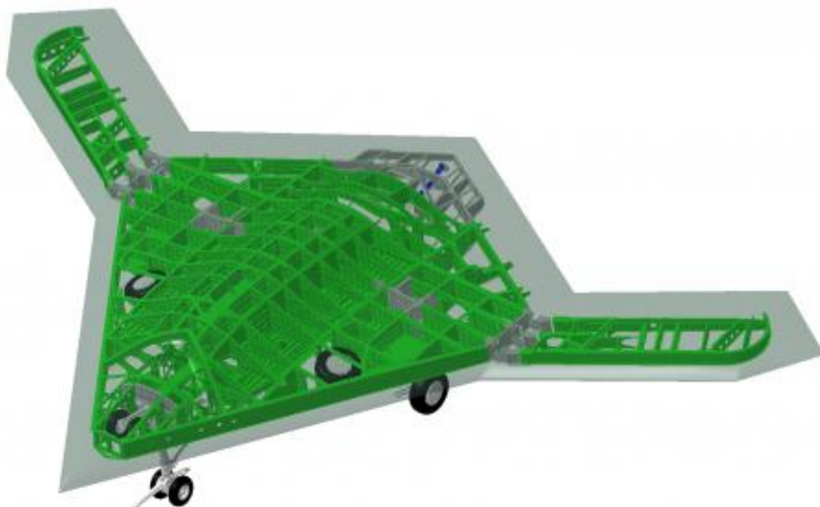
Рисунок В.2 - Компоновка БПЛА схемы «летающее крыло»
