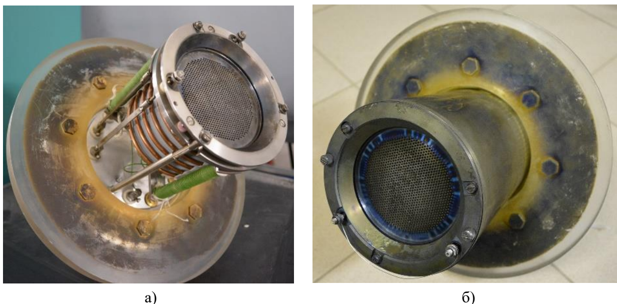
Рисунок 2.10 – Фотография лабораторной модели ВЧИД с дополнительной магнитной системой: а) без кожуха; б) с защитным кожухом.
