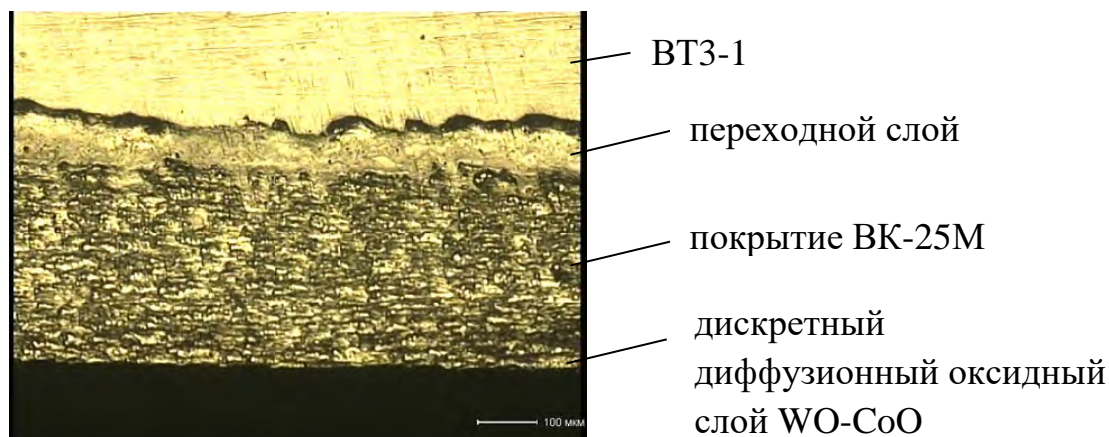
Рисунок 7.11 – Микроструктура сплава ВТЗ-1 и покрытия на лопатке компрессора.
