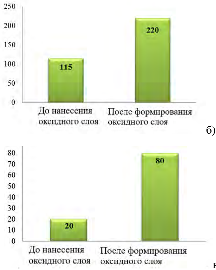
Рисунок 5.21 – Влияние модуля упругости на долговечность: а) быстрорежущая сталь Р6М5К5; б) твердый сплав ВК10ХОМ; в) титановый сплав ВТЗ–1
