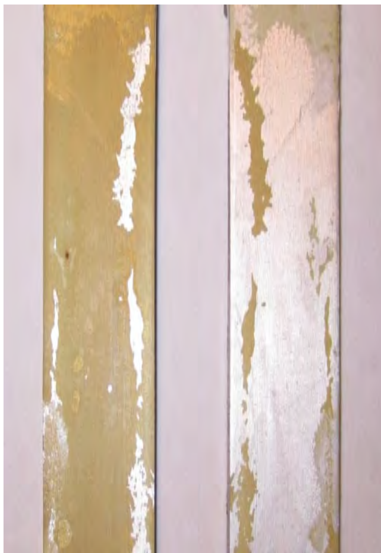
Рисунок 3.5 - Фотографии поверхностей разрушения при нагружении по моде I образцов ККС типа ДКБ на основе клея ВК-9.
