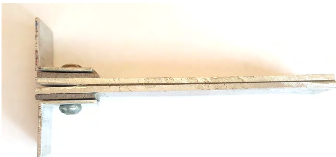
Рисунок 3.1 – Образец типа ДКБ для определения G_{Ic} .
