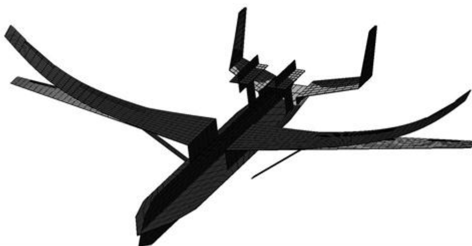
Рис. 2. Флаттер с частотой 6.75 Гц, модель без подкоса
