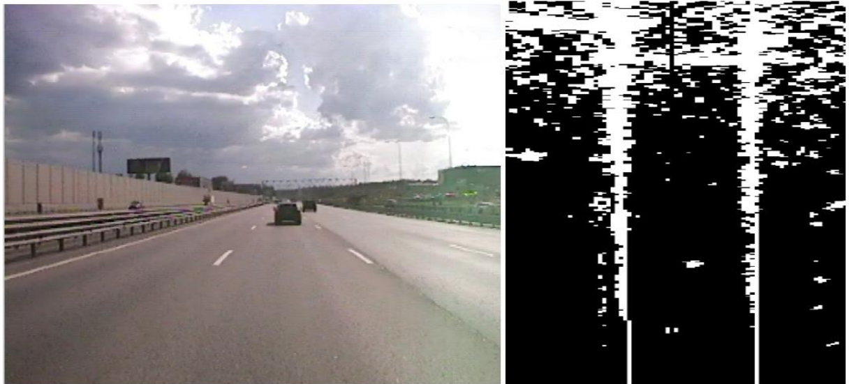
Рисунок 4.2 - Оптическое и радиолокационное изображения участка асфальтовой дороги с металлическим ограждением с нанесёнными линиями обочин
