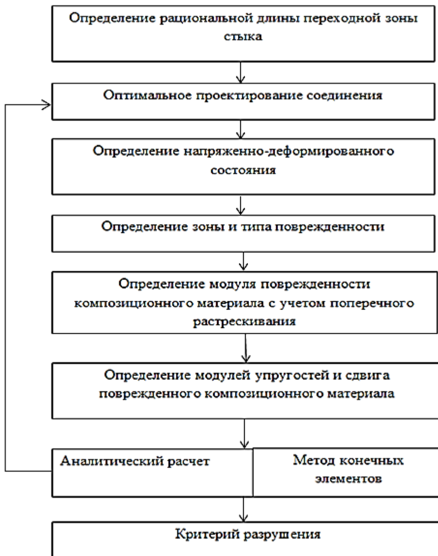
Рисунок 4– Схема алгоритма накопления повреждения для исследования зон стыка
