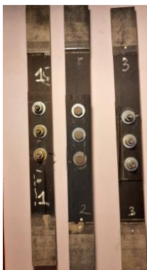
Рисунок 12 – Композитные образцы после статических испытаний
