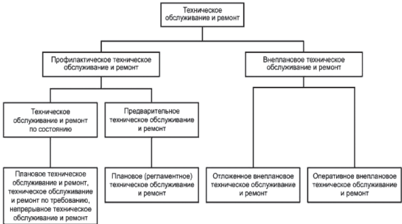
Рис. 2. Техническое обслуживание и ремонт. Общее представление
