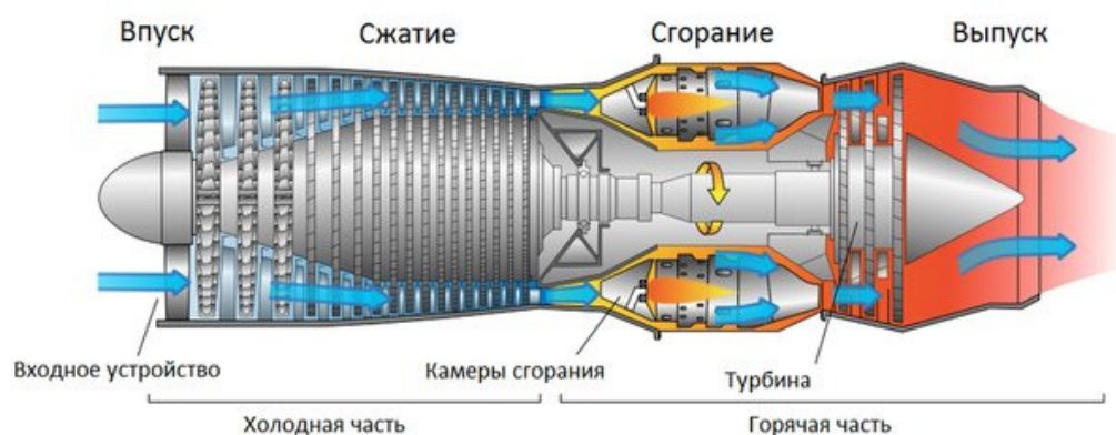
Рис. 1. Схема одновального ГТД
