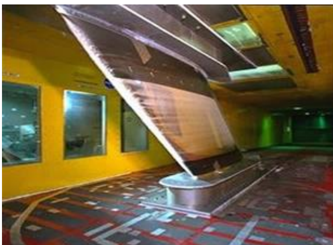
Рис. 1. Фотография образца крыла NLF-0415(2), смонтированного в рабочей камере аэродинамической трубы Математическая модель
