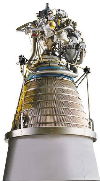
Рисунок 8. Двигатель RL-10A-4-2 с выдвигным сопловым насадком из ниобиевого сплава.
