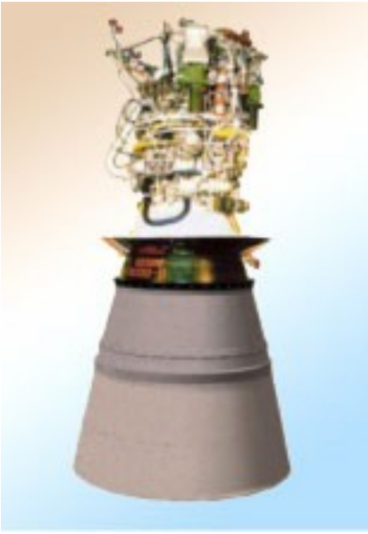
Рисунок 9. Двигатель РД-58М с сопловым насадком из УУКМ.
