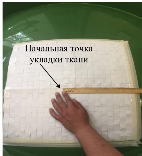
Рис. 3.7. Определение места расположения критической точки на поверхности рефлектора при выкладке ткани (схема № 1)
